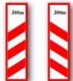
(T-28a,b) DEMİRYOLU HEMZEMİN GEÇİT YAKLAŞIMI (Sağ, Sol)
