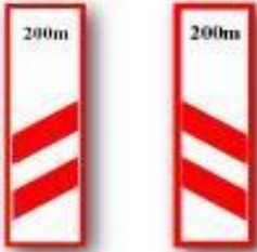
(T-29a,b) DEMİRYOLU HEMZEMİN GEÇİT YAKLAŞIMI (Sağ, Sol)
