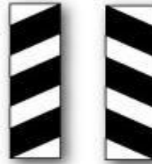
(T-31a,b) KÖPRÜ YAKLAŞIMI (Sağ, Sol)
