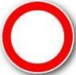
(TT-5) TAŞIT TRAFİĞİNE KAPALI YOL
